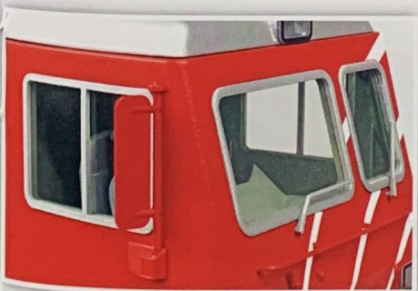
Nur bei ganz genauem Hinsehen kann man an den Ecken und den Fensterrahmen die 3D-Drucktechnik erkennen.
